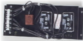
3-40306-54 Rectifier assembly, 30A
